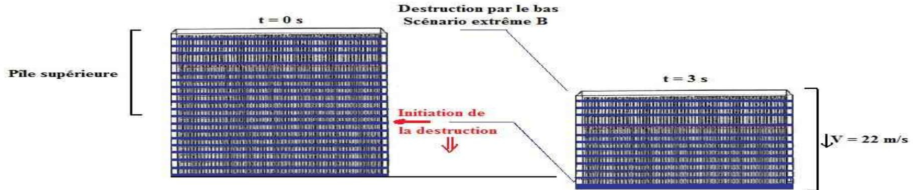
La pile supérieure descend en un bloc rigide qui détruit les étages qu'il rencontre et sa masse s'accroît de la matière de ces étages qu'elle entraîne dans sa chute
