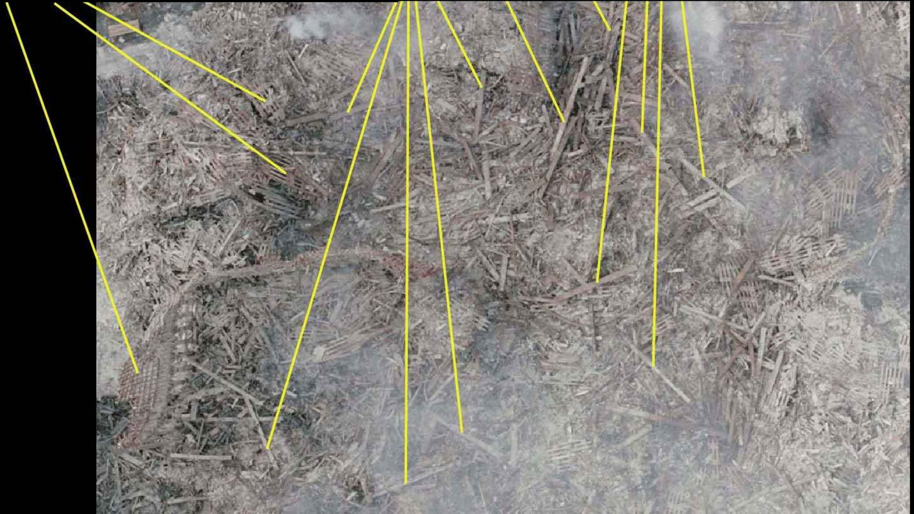
**Les colonnes ont été segmentées par les explosions. Multiples ruptures simultanées aux jonctions entre les éléments de colonne ou sections nettes par des charges coupantes linéaires. Un effondrement progressif aurait produit moins de points de rupture et plus de longues colonnes.**
