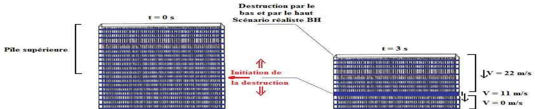
La pile supérieure n'est pas rigide: le front de destruction détruit et compacte de façon identique les étages en amont et en aval.
