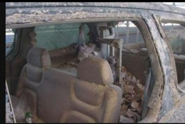
Preuve de corrosion à haute température de 1000 véhicules par le dépot du nuage corrosif près du WTC.
